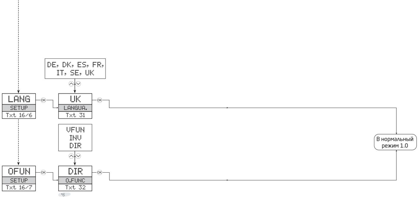
\*6 VFUN (функция U-образной выходной кривой) доступна только при условии, что выбран выходной диапазон, начинающийся с нуля.
