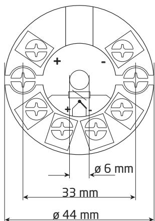
**Монтаж кабеля датчика**
