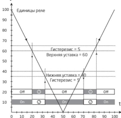
Функция реле: окно (для снижающегося сигнала)
