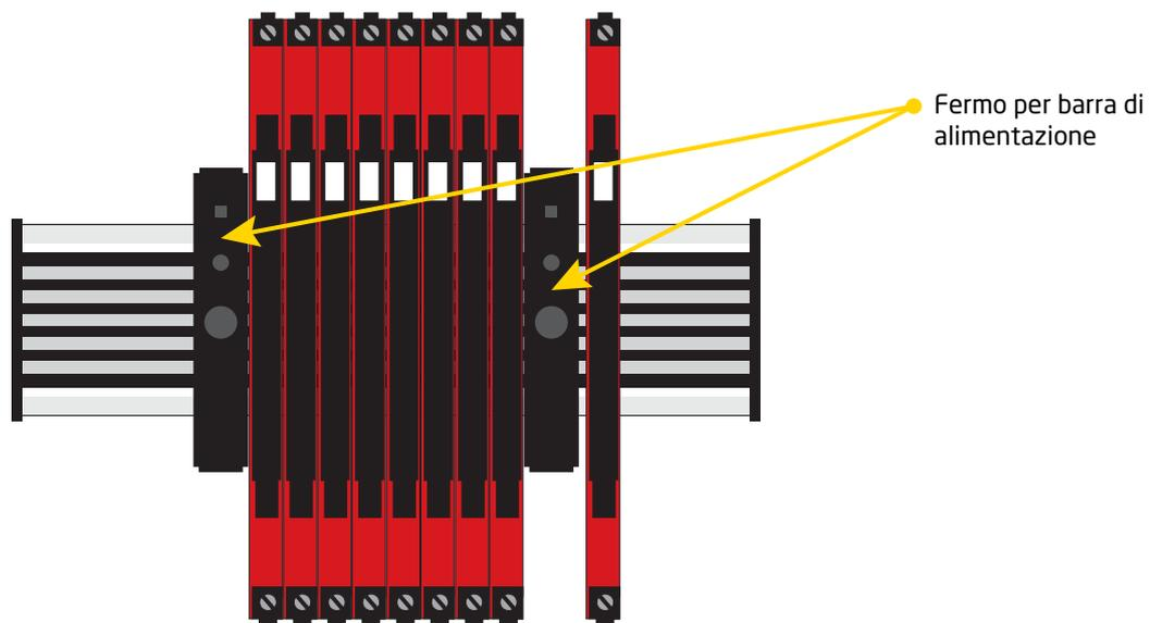
Le unità di alimentazione si possono montare sulla barra power rail in base alle esigenze del cliente.
