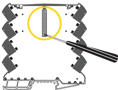
Ricordarsi di interrompere e ripristinare l'alimentazione sia della barra power rail che dei morsetti per ricaricare i valori del DIP-switch all'accensione.
