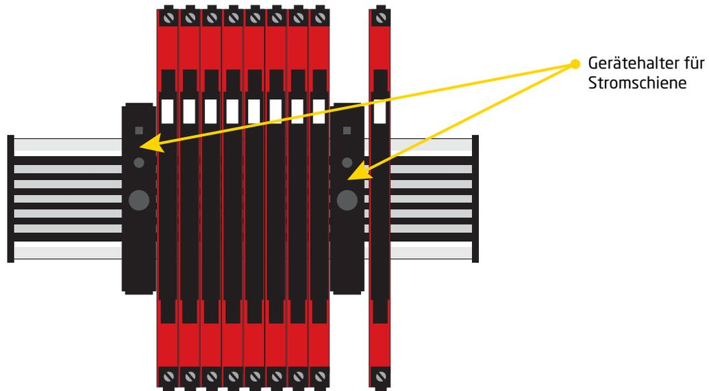
Geräte zur Versorgung können nach Anwendungsbedarf auf der Power Rail installiert werden.
