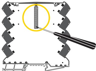
请务必重启电源导轨/端子电源，以便在开机后重新加载 DIP 拨码开关值。
