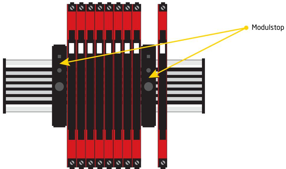
Spændingsforsyningseenheder kan monteres på power railen efter behov.
