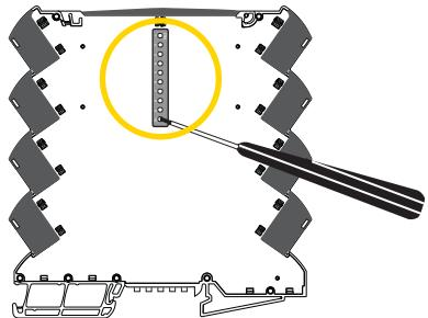
Husk at slukke og tænde for spændingen til power rail / klemmer for at genindlæse DIP-switchværdierne ved opstart.
