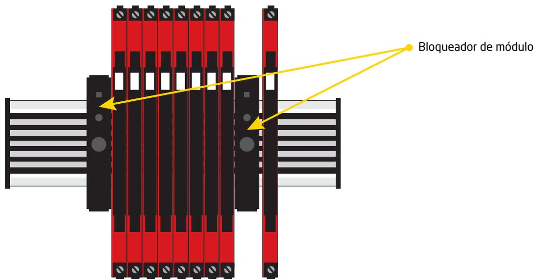
Las fuentes de alimentación se pueden montar en el power rail de conformidad con los requisitos del cliente.
