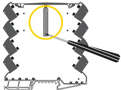
Не забудьте включить и выключить подачу питания через шину питания / клеммы, чтобы перезагрузить значения DIP-переключателей при включении питания.
