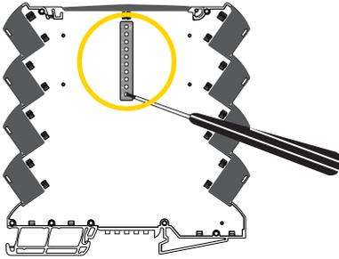
N'oubliez pas de couper l'alimentation pour le rail d'alimentation / les bornes pour recharger les valeurs des commutateurs DIP lors de la mise sous tension.
