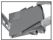
Илл. 1: Отсоедините модуль от рейки DIN, поднимая за нижний замок.
