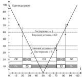
Функция реле: окно (для снижающегося сигнала)
