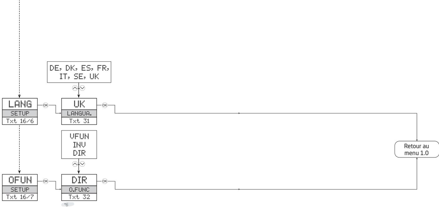
\*6 VFUN (Fonction de sortie en forme de V) Est uniquement disponible lorsque la plage de sortie configurée commence par zéro. Sortie DIR (directe) et INV (inversée) peuvent être combinées pour toutes les plages de sortie configurées.
