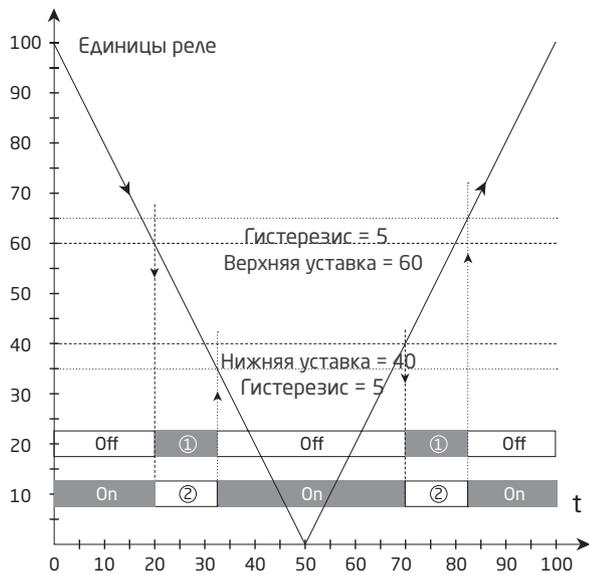
Функция реле: окно (для снижающегося сигнала)
