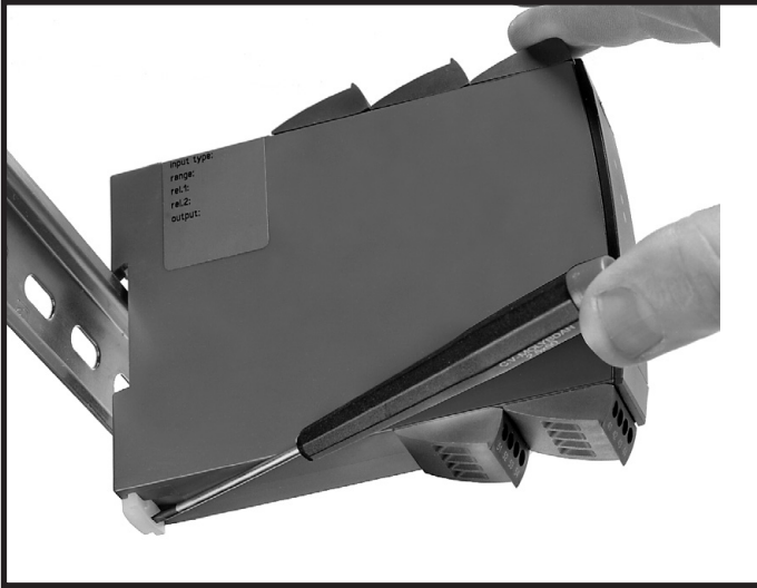
图 1： 通过移动底部锁定卡扣将设备与向下移动底部锁定装置，即可 将设备与 DIN 导轨分离。
