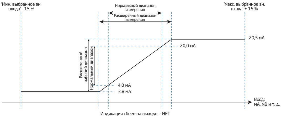
**Границы выходного сигнала и индикация сбоев - выход тока:**
