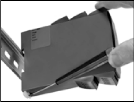
Figure 1: Detachez le module du rail DIN en relevant le verrou inférieur.
