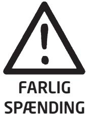
Der må ikke tilsluttes farlig spænding til modulet, før dette er fastmonteret, og følgende operationer bør kun udføres på modulet i spændingsløs tilstand og under ESD-sikre forhold:
