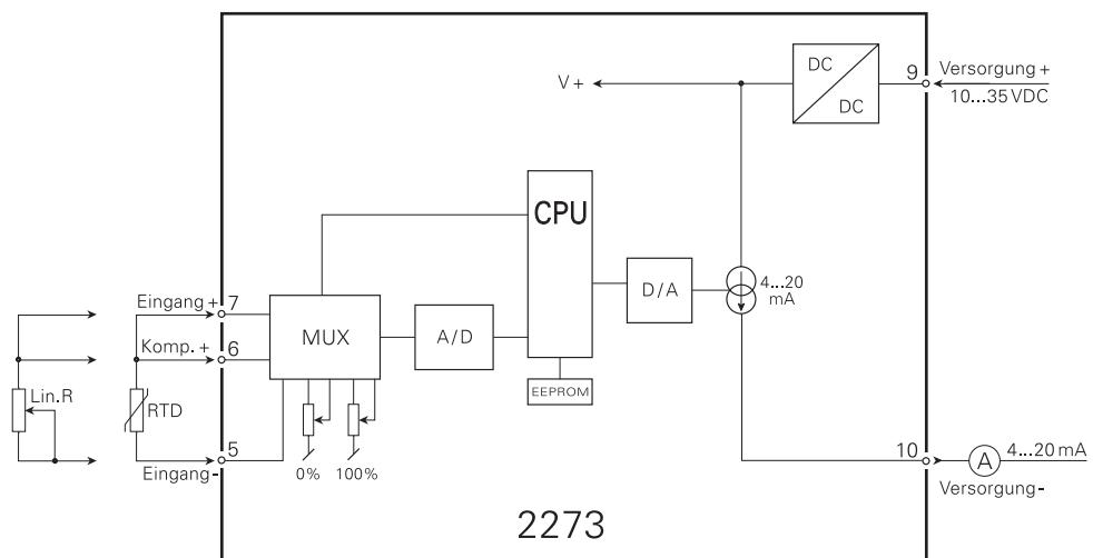
Falls ein 2-Leiter-Anschluss gewünscht wird, müssen Kontaktstift 7 und Kontaktstift 6 im Sockel kurzgeschlossen werden.
