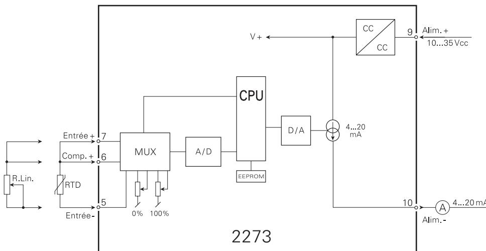
Pour un capteur raccordé en 2-fils, les bornes 6 et 7 doivent être mises en court-circuit.
