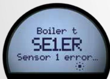
Bei einem Sensor- oder Gerätefehler hilft die rot oder weiß blinkende Hintergrundbeleuchtung, ein konkreter Fehlertext und durchlaufende Fehlermeldungen bei der schnellen Störungssuche.
