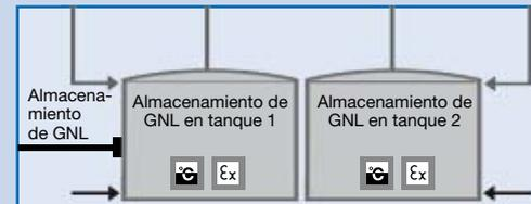
Medida del nivel con el convertidor universal **9116B** y con el transmisor de temperatura de 2 hilos programable **5334B**.
