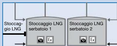
Misura di livello tramite barriera universale **9116B** e trasmettitore di temperatura a tecnica due fili **5334B**.
