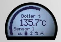
A través del cristal, puede supervisar fácilmente el valor del proceso y el gráfico de barras radial indica de un vistazo la magnitud del proceso. Una etiqueta del dispositivo personalizada, una etiqueta del valor del proceso y los campos de unidad facilitan la identificación del punto del proceso visualizado.
