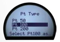
La conocida estructura de menús sencillos de PR proporciona una ruta de configuración guiada que hace que la configuración del transmisor resulte rápida e intuitiva.
