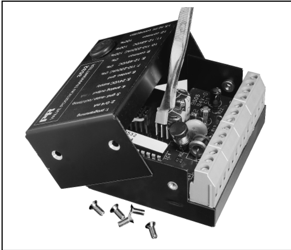
Billede 1: Adskillelse af og jumperplacering på 3532.
