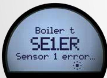
Quando si verifica un errore del sensore o del dispositivo, una spia rossa o bianca lampeggiante, il testo dell'errore specifico e messaggi di errore scorrevoli ne agevolano la risoluzione.
